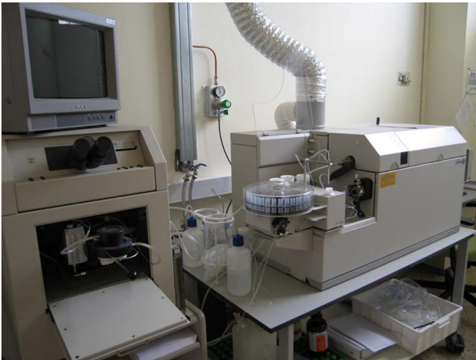
Fig. 3.- Sistema LA-ICP-MS del IGME (Laboratorio de Tres Cantos)
