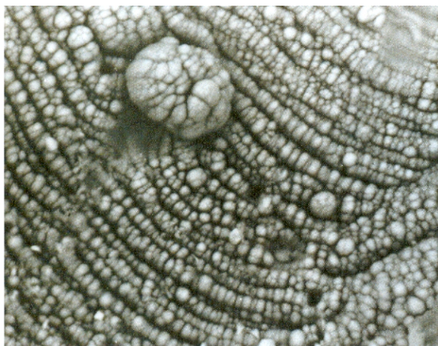
Fig. 2.- Microparticulado producido por ablación. Imagen SEM de electrones secundarios. J.S.Cózar CIEMAT
